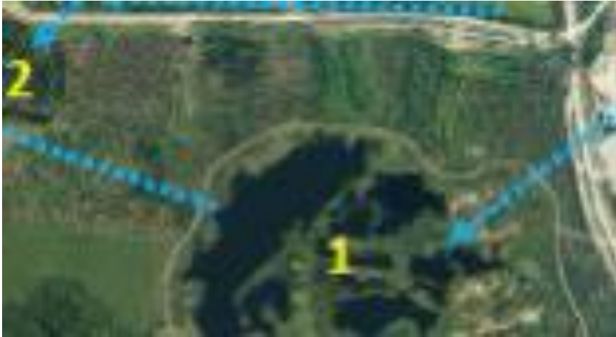
Kuva 2. Sulkemissuunnitelman mukainen maa-aineksen ottoalue, josta on muodostettu vesienkäsittely-yksikkö.
