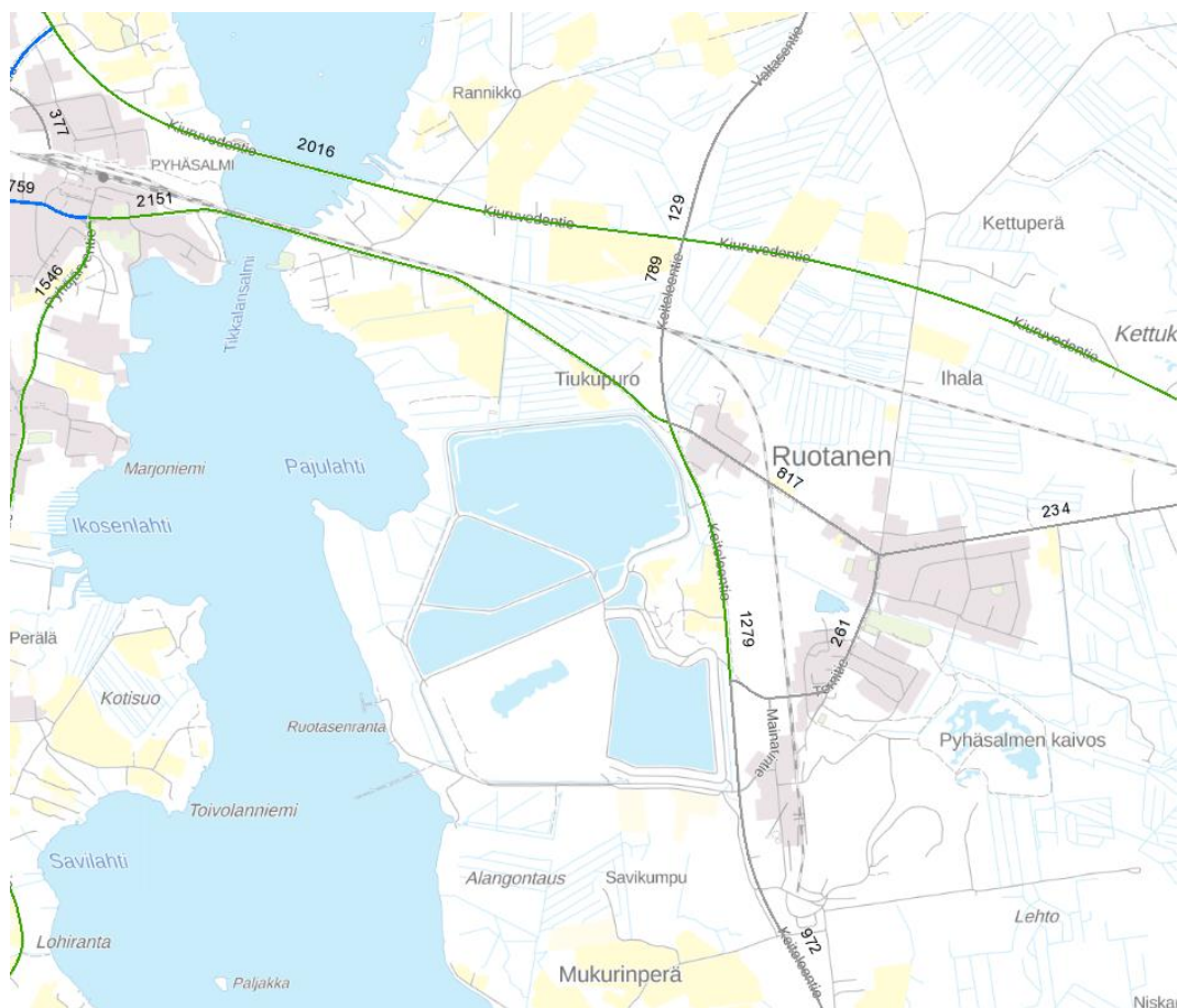
Kuva 15. Ruotasan kaivosalueen pohjoispuolella Keiteleentien liikennemäärät on noin 1280 ajoneuvoa/vrk. ja eteläpuolella 972 ajoneuvoa/vrk. Raskasta liikennettä on noin 91 ja 59 ajoneuvoa/vrk. (2017).
