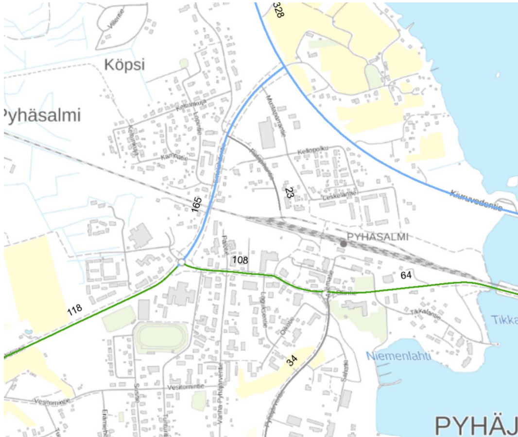
Kuva 3. Emolahdentien raskaan liikenteen liikennemäärät Pyhäjärventien kiertoliittymän pohjoispuolella ovat 165 ajoneuvoa/vrk , kiertoliittymän itäpuolella Ollintiellä 108 ajoneuvoa/vrk ja eteläpuolella 118 ajoneuvoa/vrk. Ratapihantiellä 23 ajoneuvoa/vrk. ( https://vayla.fi/kartat/liikennemäärakartat )
