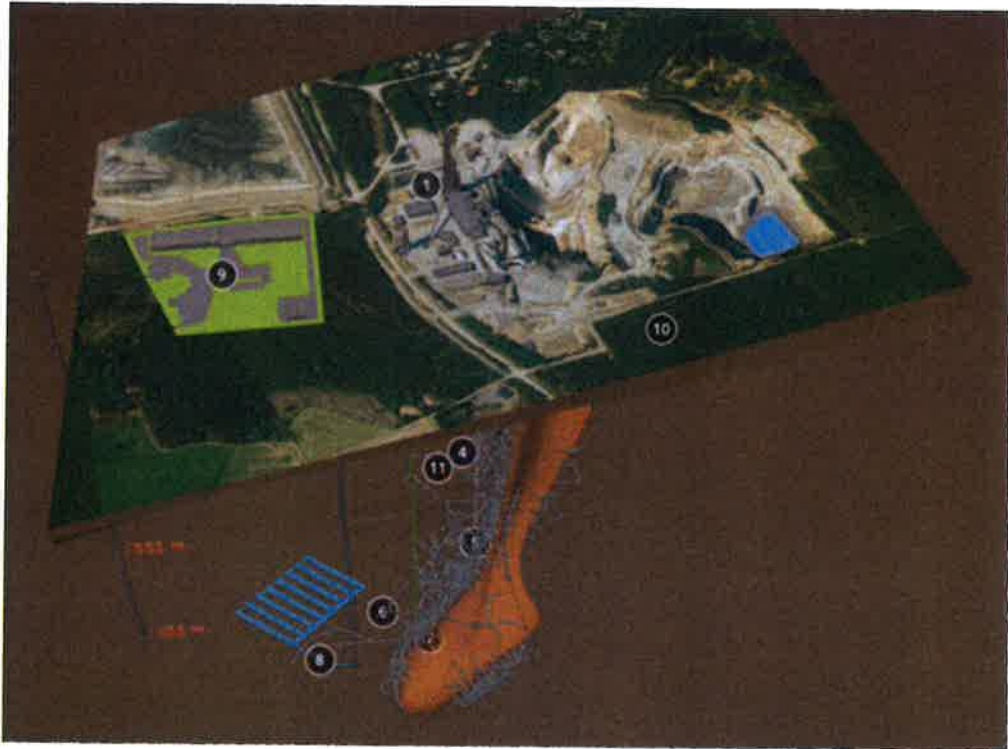
Kuva 7. Periaatekuva säätövoimalan sijoittumisesta alueelle. Vesi johdetaan ylävesialtaasta maan- alaista putkistoa pitkin pystysuuntaiselle pudotusputkelle, missä vesimassat pudotetaan alas aina 1500 metrin syvyyteen ja pumpataan jälleen yläaltaalle edullisemmalla ”yösähköllä”. Suunnitelma perustuu suljettuun vedenkiertoon ( https://callio.info/fi/ ).
